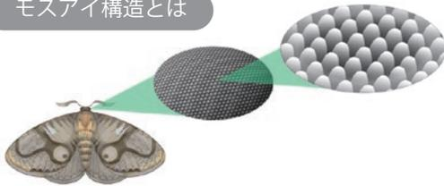
蛾（モス）の目（アイ）と同じような 100~200nm サイズのナノ凹凸表面構造を工業的に作り出す技術です
