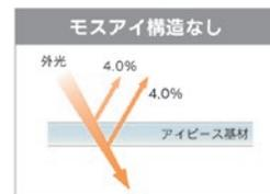
微細な凹凸により屈折率を連続的に変化させることで、ほぼすべての光の反射を防ぐことができます。
